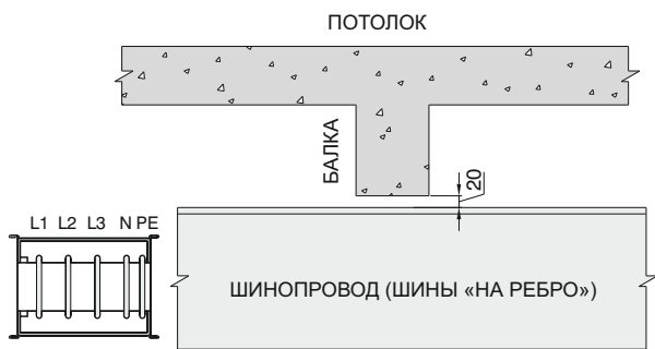
Рисунок 7. Проход под балкой на горизонтальном участке (шины «на ребро»)
